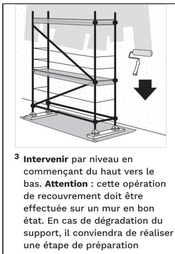
**3 Intervenir** par niveau en commençant du haut vers le bas. **Attention** : cette opération de recouvrement doit être effectuée sur un mur en bon état. En cas de dégradation du support, il conviendra de réaliser une étape de préparation
