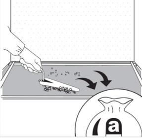
**7 Mettre** dans un sac déchets amiante les carreaux de faïence et les résidus issus du raclage au fur et à mesure de l'intervention
