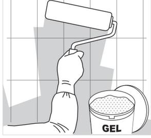
**4 Appliquer** à l'aide d'un rouleau ou d'une brosse du gel hydrique sur la surface à traiter
