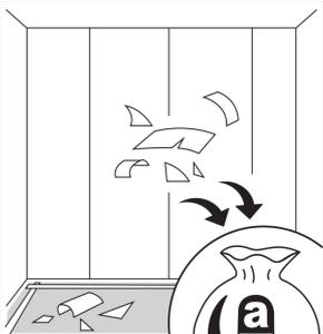
**9 Mettre**, au fur et à mesure, les déchets issus du recouvrement dans le sac déchets amiante
