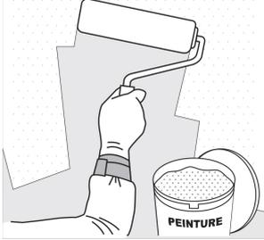
**4 Appliquer** la peinture au rouleau ou à la brosse. **Attention** cette opération de recouvrement doit être effectuée sur un mur en bon état. En cas de dégradation du support, il conviendra de réaliser une étape de préparation
